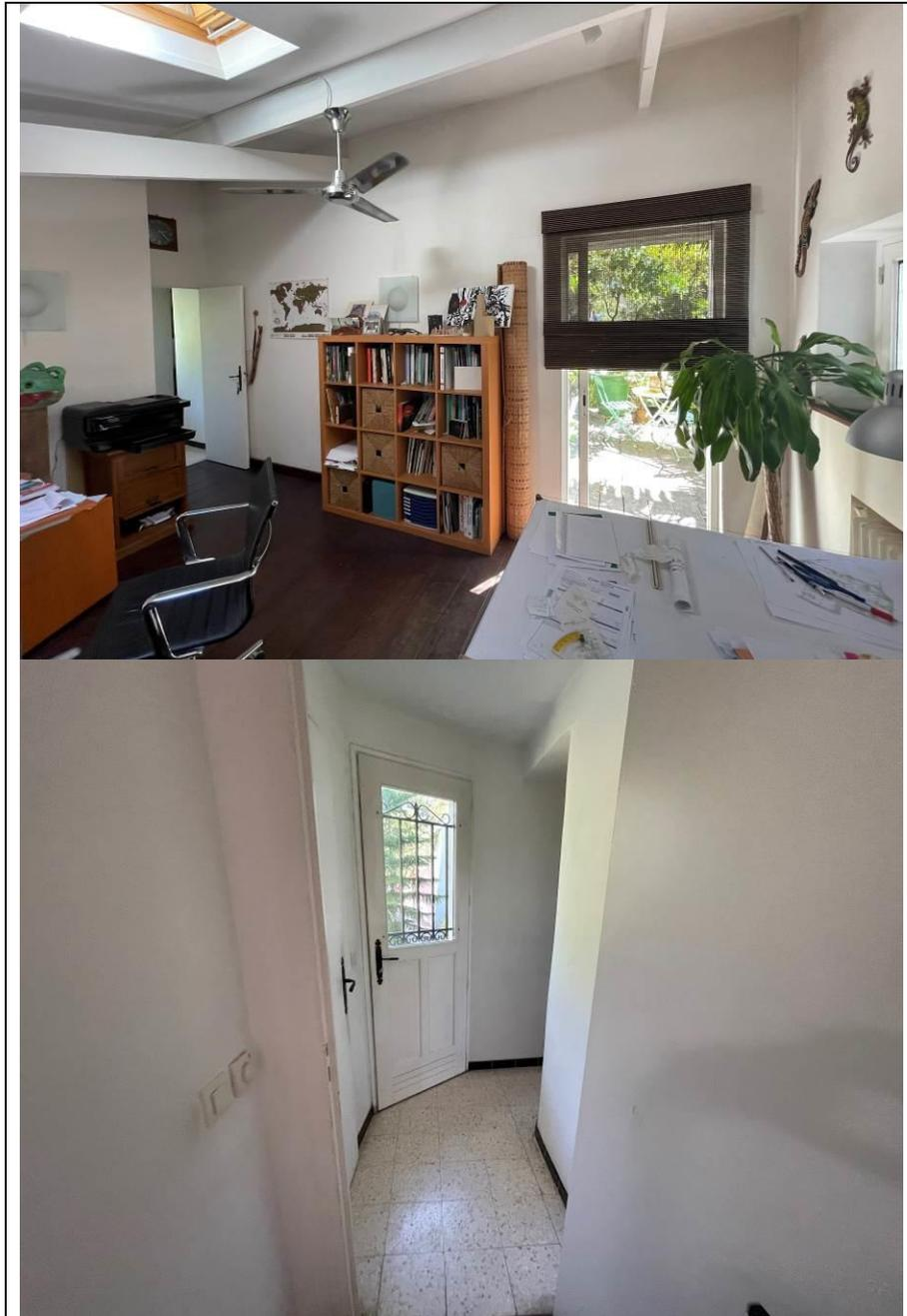
Il s'agit d'une pièce rectangulaire aérée et éclairée au Sud au moyen d'une porte-fenêtre, vantaux coulissants à galandage, menuiserie en aluminium, un carreau de vitre double vitrage, ainsi que par deux fenêtres, menuiseries en bois, un carreau de verre granité et grille de défense. L'obscurité pour la baie vitrée est assurée par un volet roulant à commande électrique.
